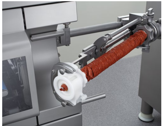
Darmbremsassistent - halbautomatisches Darmbremshaltersystem
