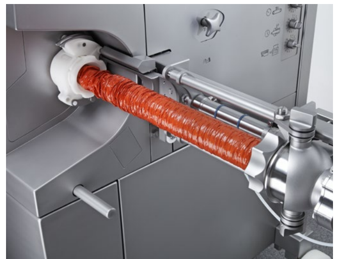
Sicherheitsdarmbremse mit Eingriffsschutz
