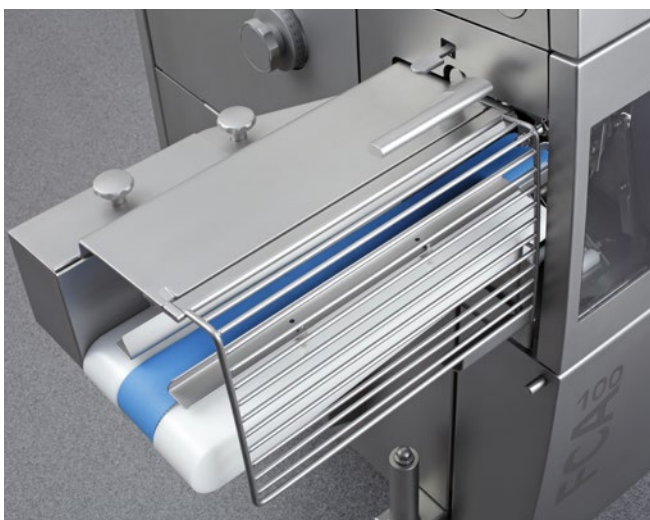
Förderband im Hygienesdesign, mit einem Griff entnehmbar
